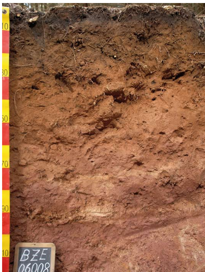
Weitverbreiteter hessischer Waldboden – Löß über Buntsandstein, SWB vz : -122 mm, Trophie: mesotroph Foto: NW-FVA
