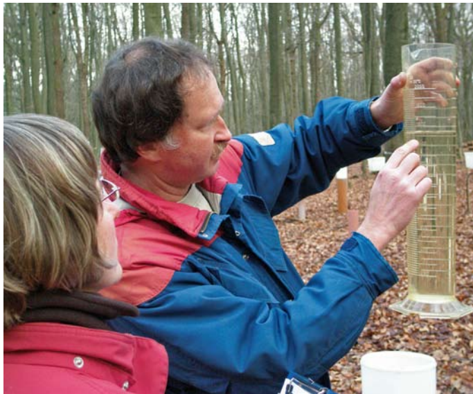
Erfassung der Niederschlagsmenge
