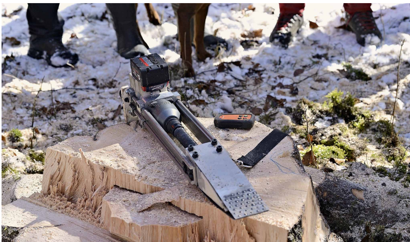
Der Fällkeil mit Fernsteuerung
