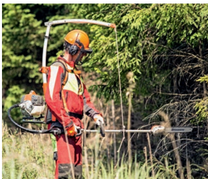
Der „Spacer“ mit als kritisch betrachteter Überkopfkonstruktion
