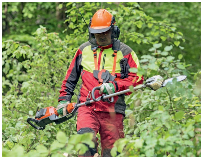
Leichter Transport durch elastisches Tragegurtsystem
