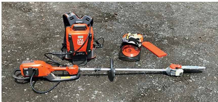
Akkupflegesäge von Husqvarna (530iPX) mit Akku-Rucksack
