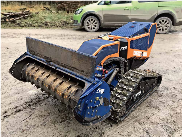
Eingesetzte Raupe mit Forstmulcher Irus Deltrak 2.5
