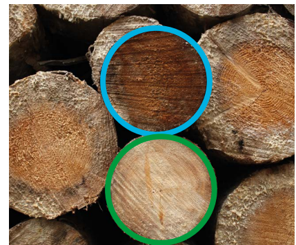
Bild 3 und 4: Vergleich angeschnittene Stirnflächen Fi: blaue Kennzeichnung: vor dem Anschnitt, grüne Kennzeichnung: nach dem Anschnitt
