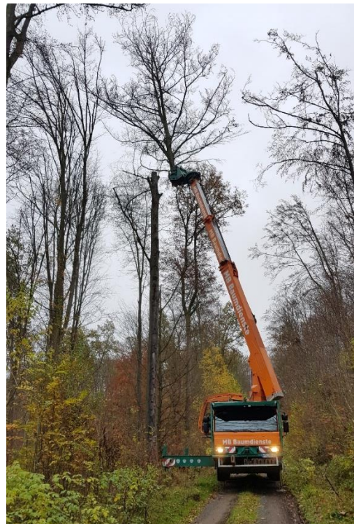
Abbildung 4: Fällkraneinsatz im Revier Schwarzenfels
